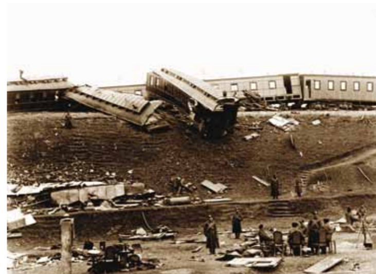
На разрушенный вагон-столовую должны были наехать следующие за ним вагоны, но два ближних к нему развернулись на стальных рельсах поперек, образовав баррикаду. Однако последовавший удар был столь силен, что проломило вагонную стенку. Фото А. М. Иваницкого.
